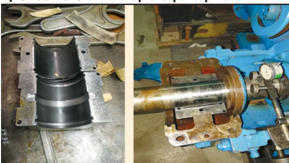
Рис. 4. Стендовые испытания подшипников для ЦНС-180 в ЗАО «Нижневартовскремсервис»
